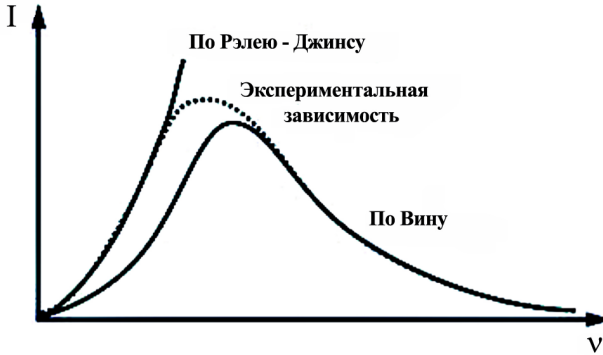
Рис. 4.2. Спектр излучения абсолютно черного тела Теоретические предсказания и экспериментальная зависимость спектра излучения абсолютно черного тела.
